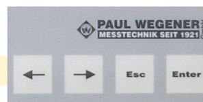
display e tastiera per la visualizzazione dei dati di misura (attuali, min./max.), avvio/arresto della misurazione, impostazione dei principali parametri
